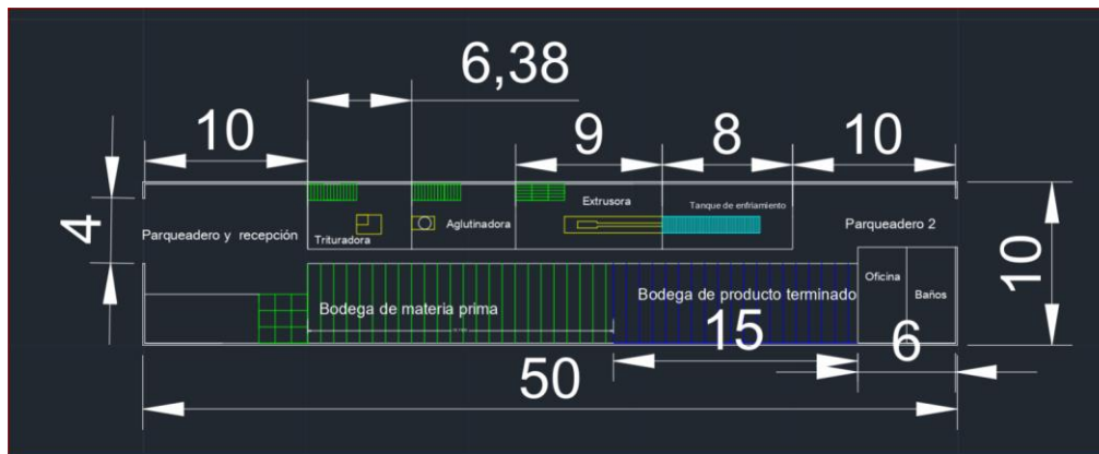
Ilustración 27. Distribución de la planta de producción
